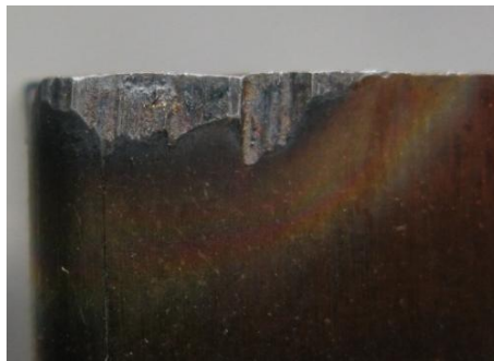
Рисунок 5 – Фаска зношування по задній поверхні різальної пластини
