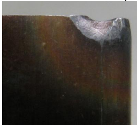
Рисунок 4 – Лунка зношення по передній поверхні різальної пластини
